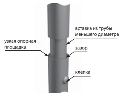
Фрагмент соединения старой конструкции
